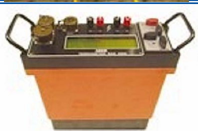
Terrameter SAS 4000, 4 - канальная ABEM, Швеция
