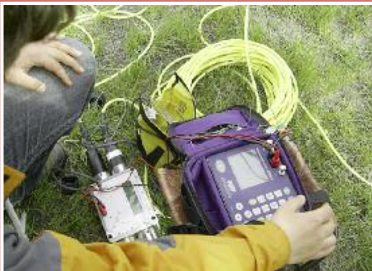
Рис. 5. Полевые работы с коммутатором COMx64 в комплекте с измерителем МЭРИ-24.
