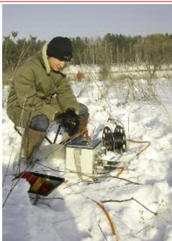
Рис. 8. Полевые работы на зимней практике со станцией Syscal-Pro.
